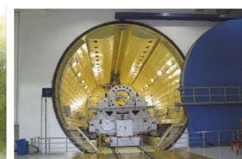
上海电气临港基地 350t 高速动平衡试验室
